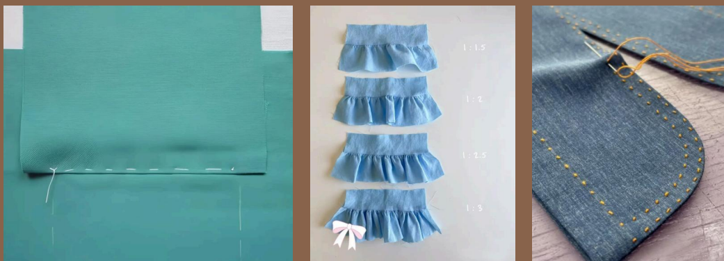
图1-29 疏缝（左）、缩缝（中）、星点缝（右）
